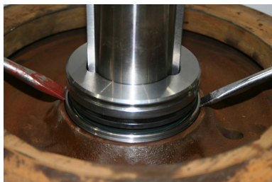
Рис. 18: Извлечение торцового уплотнения с помощью монтировок
